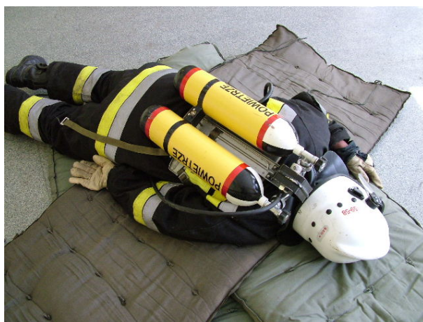
Fot. 2. Sygnalizator bezruchu znajduje się pod nieprzytomnym strażakiem
